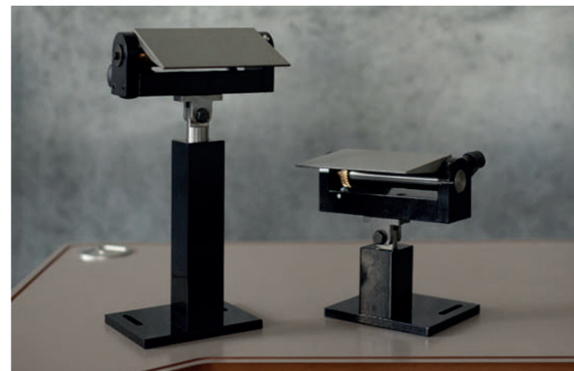
Piani di lavoro per lapidello e cartatrice inclinabili, orientabili e regolabili in altezza
